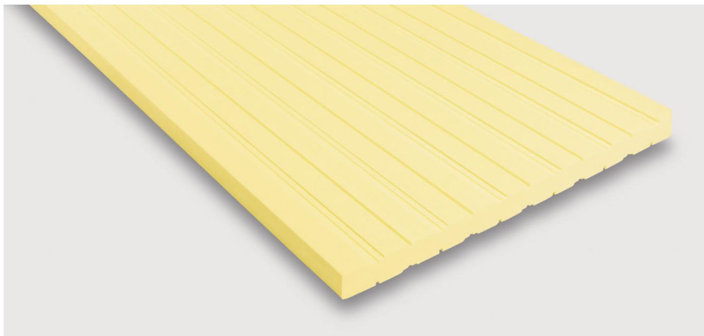
**POLYPANN - PIL** › Lastra di polistirene espanso estruso con superfici ruvide ad intonaco e fresature su entrambe le facce. Viene normalmente impiegato per evitare la formazione di ponti termici. Le fresature simmetriche permettono la facile e perfetta frattura del pannello al fine di utilizzare la porzione necessaria in relazione alla dimensione del pilastro stesso senza la necessità di utilizzare utensili. Il tipo di finitura superficiale permette l'ottima adesione al calcestruzzo.
