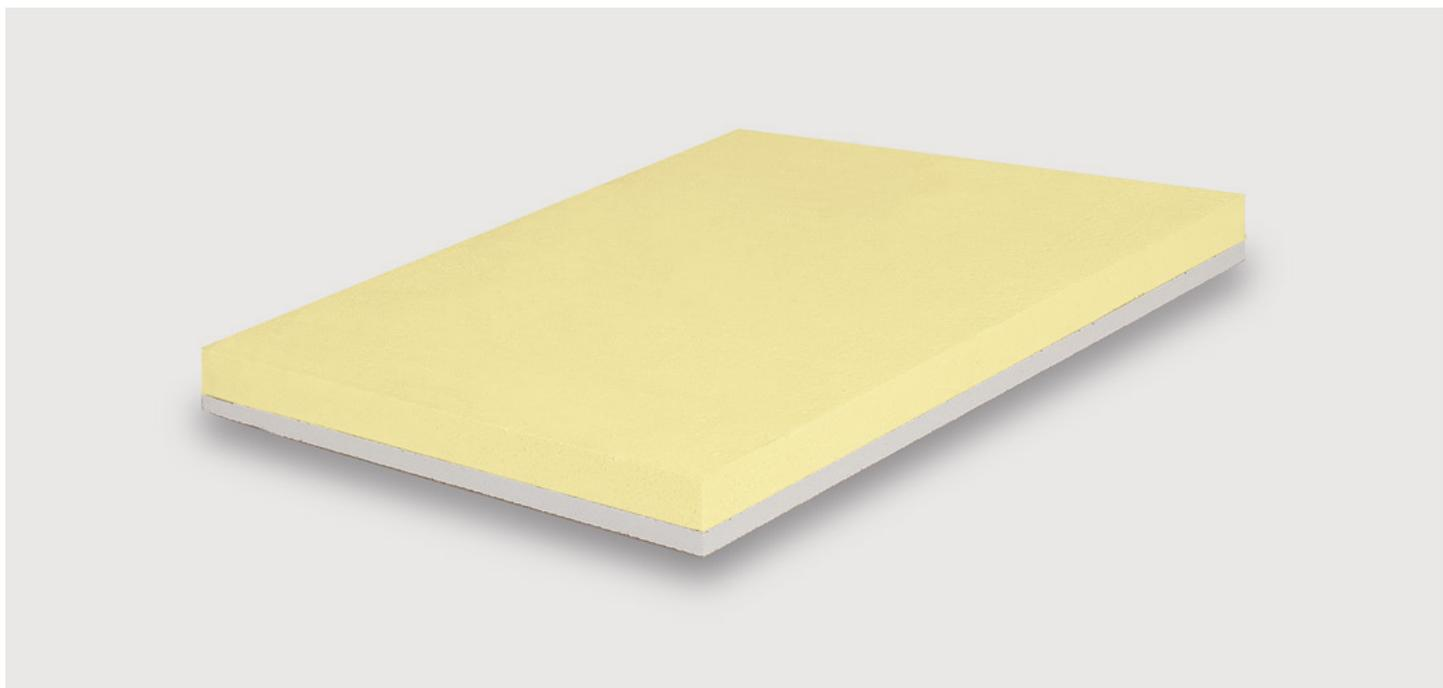
**POLYPANN - CTG** › Pannello semisandwich prefabbricato composto da una lastra di cartongesso di spessore 13 (o 10) mm accoppiata a una lastra di polistirene estruso senza pelle di estrusione e finitura a bordi dritti sui quattro lati. I pannelli hanno una larghezza pari a 1200 mm, lunghezza 3000 (o 2000) mm e sono disponibili in vari spessori. Indicato per l'isolamento dall'interno di pareti e soffitti.
