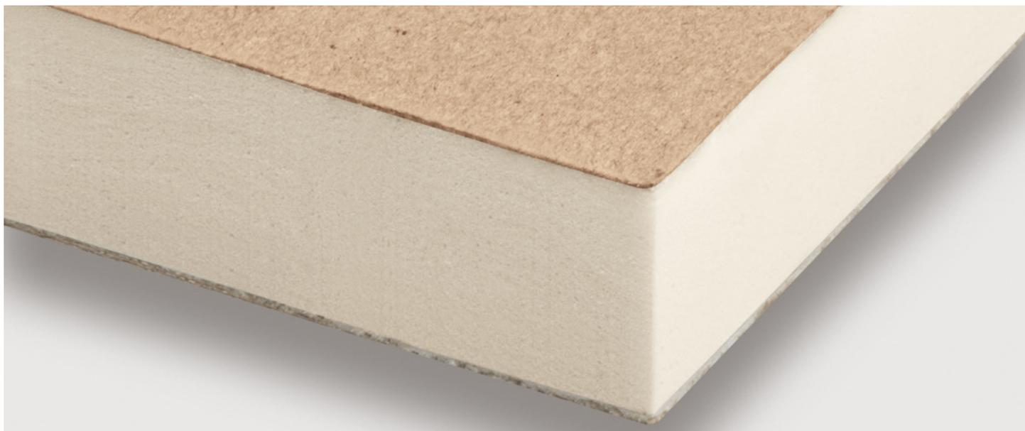
**ISOLITE CK** è un pannello in schiuma polyiso, rigida a celle chiuse, senza l'impiego di CFC o HCFC tra due rivestimenti in carta kraft. I pannelli hanno valori di resistenza alla compressione  $\geq 100$  kPa, sono ideali per l'applicazione in parete cava e dichiarano valori di  $\lambda_D$  da 0,026 a 0,028 W/mK in funzione dello spessore, secondo la norma europea EN 13165. I pannelli hanno bordi dritti, dimensioni standard 600 x 1200 mm e sono disponibili negli spessori da 30 a 100 mm.
