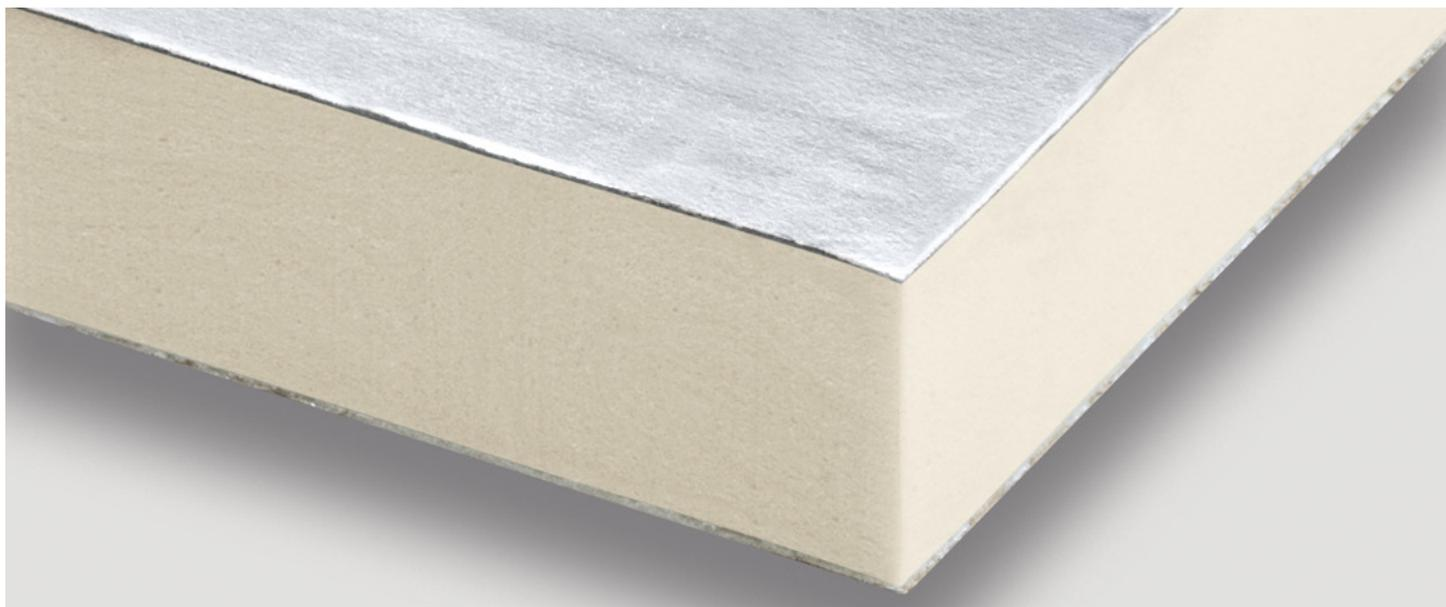
**ISOLITE EXTRA** è un pannello in schiuma polyiso, rigida a celle chiuse, senza l'impiego di CFC o HCFC tra due rivestimenti di alluminio multistrato. I pannelli hanno valori di resistenza alla compressione  $\geq 150$  kPa. Dichiarano valori di  $\lambda_D$  pari a 0,022 W/mK secondo la norma europea EN 13165.
