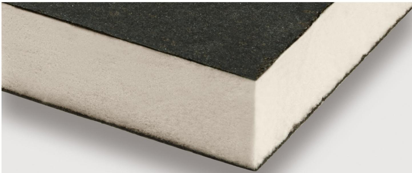
**ISOLITE CFB** è un pannello in schiuma polyiso, rigida a celle chiuse, senza l'impiego di CFC o HCFC tra due rivestimenti in cartongesso bitumato. I pannelli hanno valori di resistenza alla compressione  $\geq 130$  kPa, sono idonei per l'applicazione sotto membrana bituminosa a caldo (resistendo a temperature di esercizio fino a 110 °C) e dichiarano valori di  $\lambda_D$  da 0,026 a 0,028 W/mK in funzione dello spessore, secondo la norma europea EN 13165.
