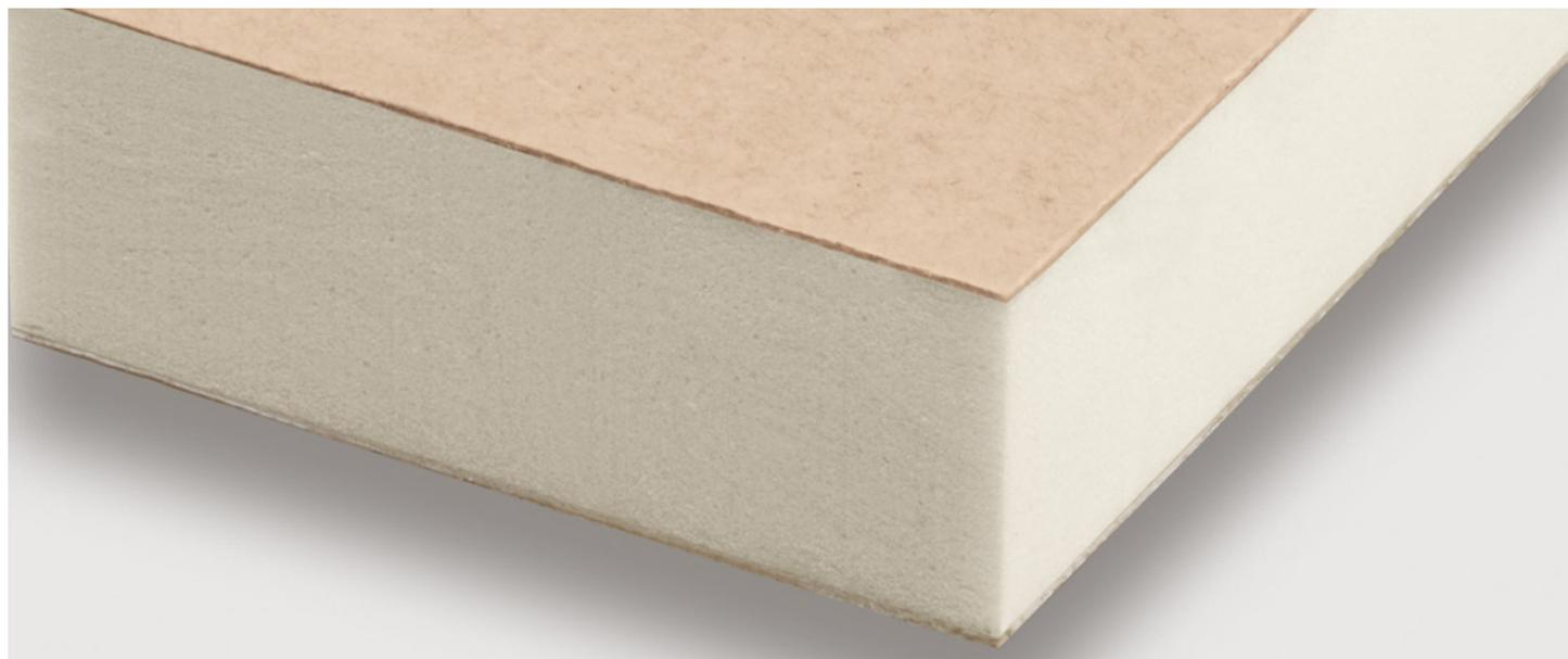
**ISOLITE PIR PLUS** è un pannello in schiuma polyiso, rigida a celle chiuse di colore giallo, senza l'impiego di CFC o HCFC tra due rivestimenti in carta metallizzata multistrato. I pannelli hanno valori di resistenza alla compressione  $\geq 150$  kPa, dichiarano valori di  $\lambda_D$  pari a 0,022 W/mK secondo la norma europea EN 13165.
